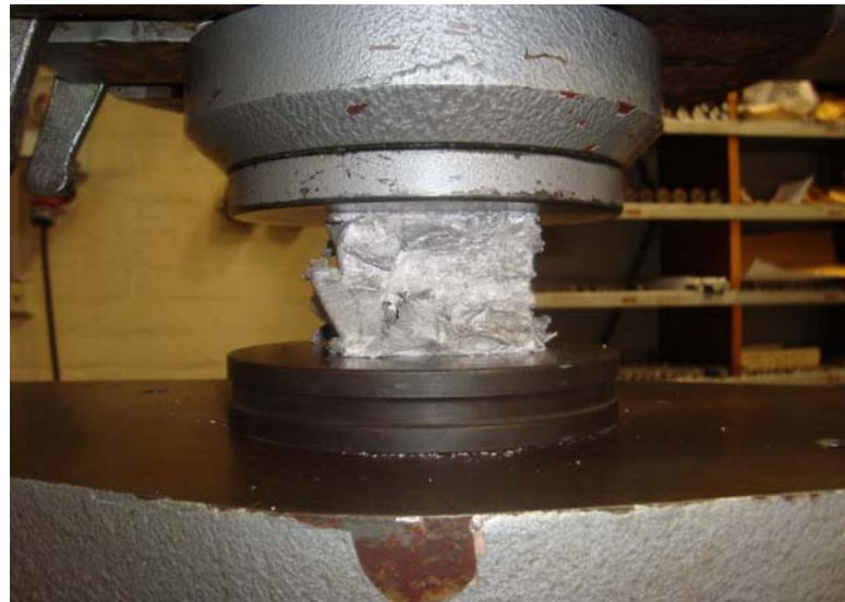
Slika 3 – Tlačno ispitivanje uzorka aluminijске pjene
