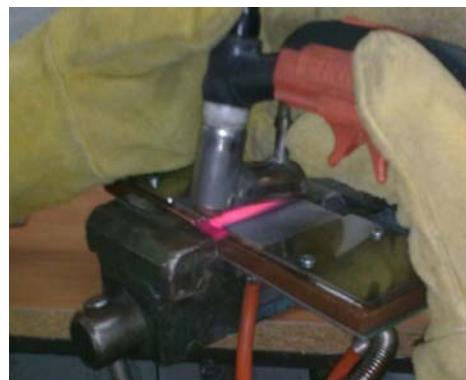
*Slika 6. Zavarivanje probnih uzoraka*
