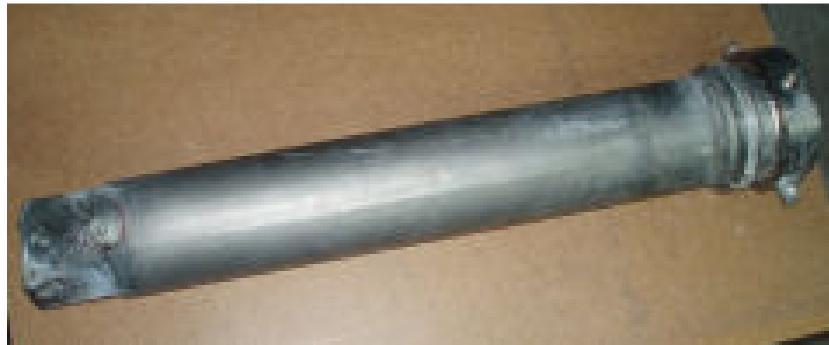
Slika 1. Kućište TV kamere iz titan slitine
