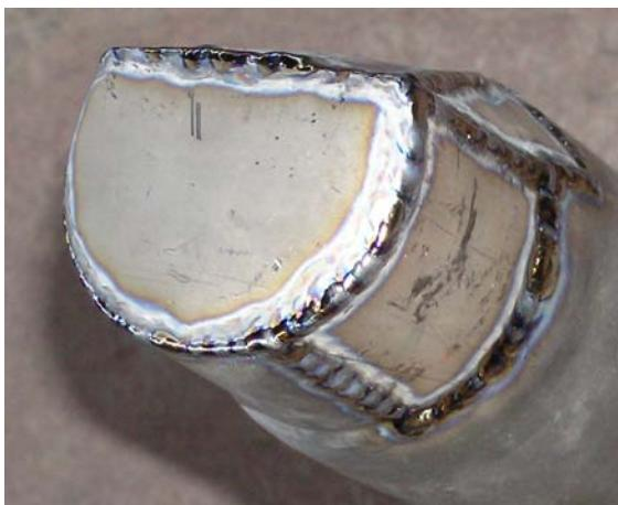
*Slika 18. Zavareni plašt kućišta TV kamere prije čišćenja oksida*
