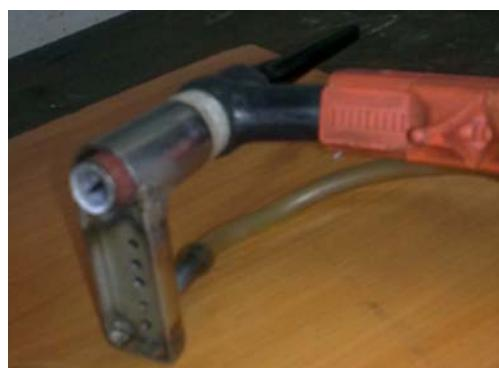
Slika 8. Naprava za sekundarnu zaštitu lica zavara
