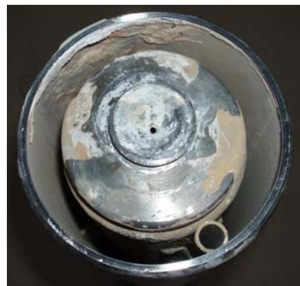
*Slika 16. Kamenac u unutrašnjem dijelu kućišta*
