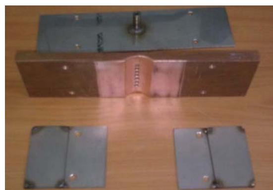
Slika 7. Naprava za zavarivanje uzorka
