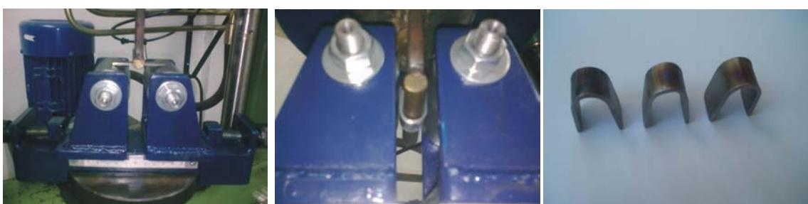
*Slika 13. Savijanje epruveta i epruvete nakon savijanja*
