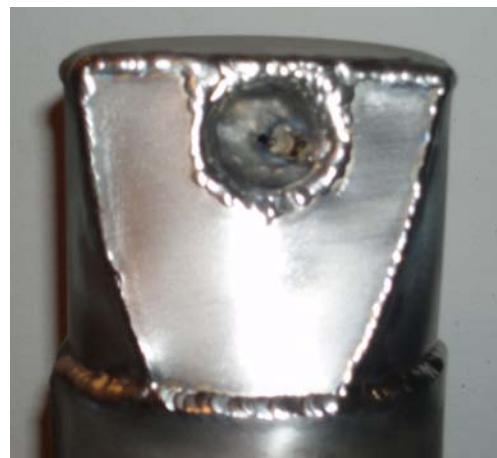
*Slika 19. Zavareni plašt kućišta TV kamere nakon čišćenja oksida*
