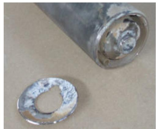
*Slika 5. Kamenac na unutarnjem dijelu plašta*
