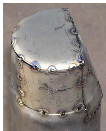
*Slika 17. Pripojeni dio plašta kućišta*
