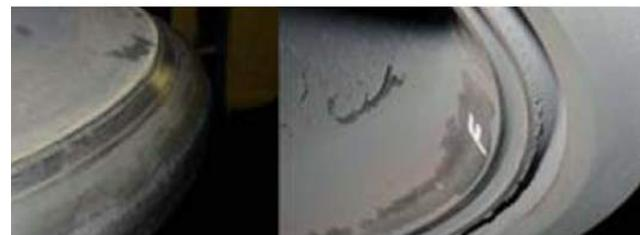
**Slika 13.** Izgled „NIMONIC 80A“ ispušnog ventila i „W“ sjedišta nakon 36400 radnih sati, [7][9][10][11]
